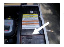
SHUT THE NEVER DARK GENERATOR OFF BY PRESSING THE ROCKER SWITCH TO THE OFF POSITION.
